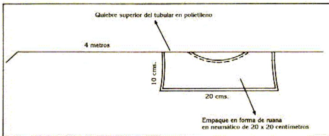
FIGURA 5. Localización de un empaque en neumático de 20 x 20 centímetros sobre la bolsa.
